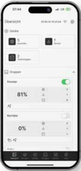
LiveLink LAN DR • DALI-2 APC max. 64 apparaten • Inbedrijfstelling via WLAN en app • Verbinding met hogerliggende systemen via MQTT EAN 4007841 055455
